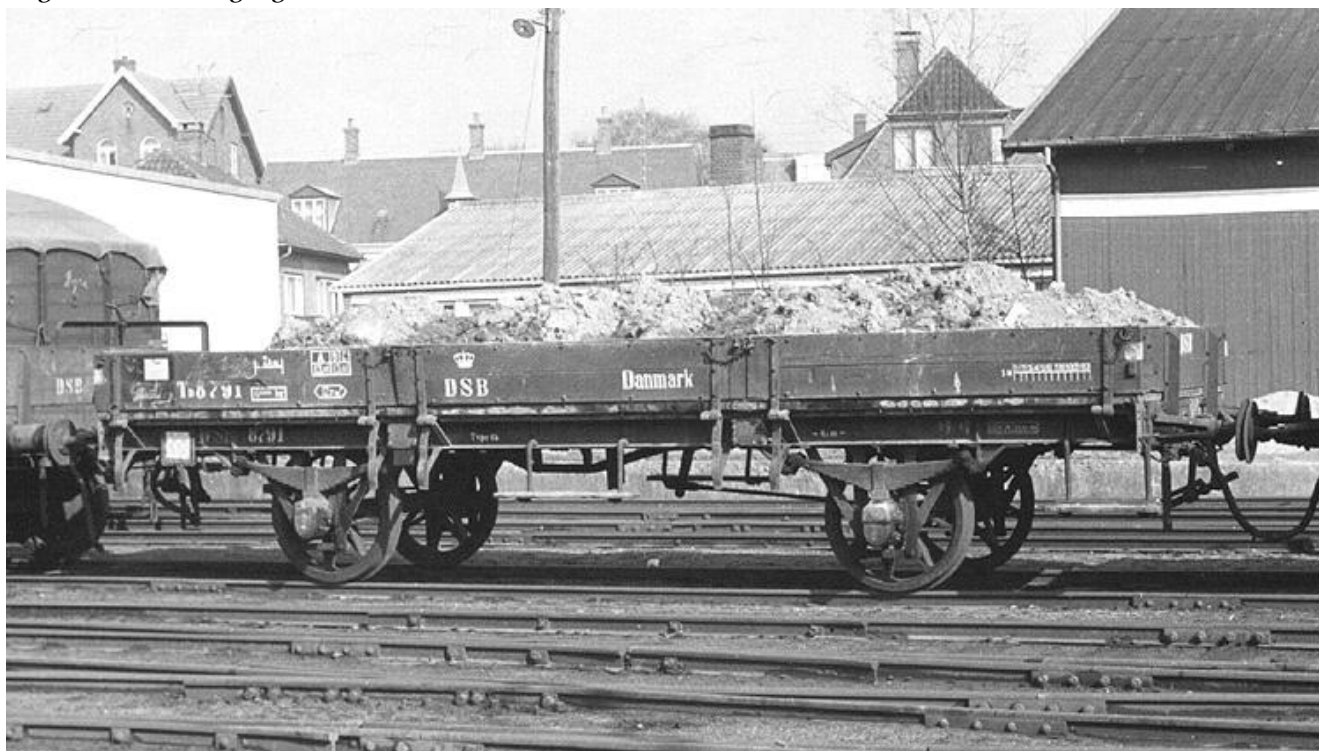
TD 8791. I Frederikssund, "den evige grusvogn" En skøn gammeldags vogn med stjernehjul, spinkle åbne akselgafler, dråbelejer og kurvpuuffer. Bygget af Scandia 1907 til KSB T 427 og udrangeret i 1965. Foto.: Hans Gerner Christiansen.
